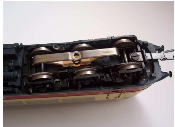
frotador en el centro, entre las ruedas, por donde captan una polaridad eléctrica y la otra polaridad la captan por las ruedas. En el sistema de dos carriles una polaridad la captan por las ruedas de la derecha y la otra polaridad por las ruedas de la izquierda. ¿Cuál de ellas es mejor? Hay respuestas para todos los gustos.
